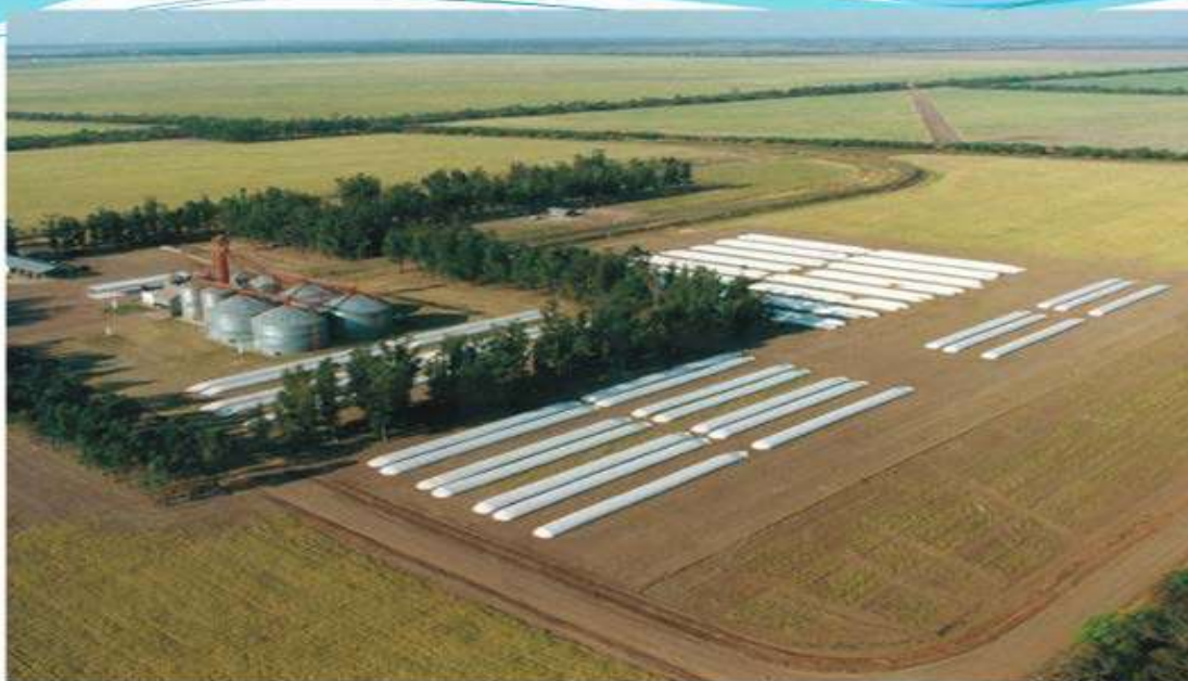
30-rasm. Dala sharoitida germetik usulda egiluvchan polietilen englarda don saqlash.
